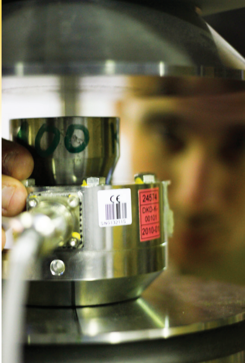
Calibração da transdutor de força: um dos inúmeros serviços prestados à indústria pela Dimec
